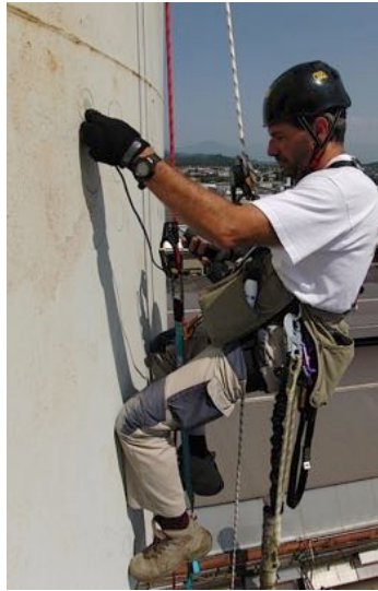
Determinazione spessore lamiera in quota
