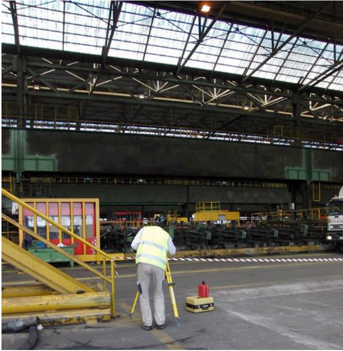
Rilievo geometrico struttura capannone industriale
